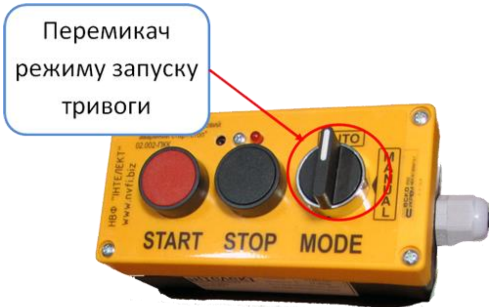
Малюнок 1.1.2 Перемикання режиму запуску тривоги пост ПКК 02.002
