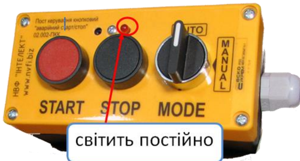
Малюнок 5.2. Світлодіодний індикатор з убудованим звуковим випромінювачем
