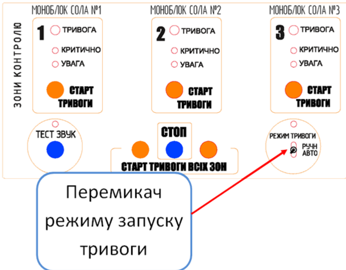
Малюнок 1.1.3 Перемикання режиму запуску тривоги пульт ПКК 02.003
